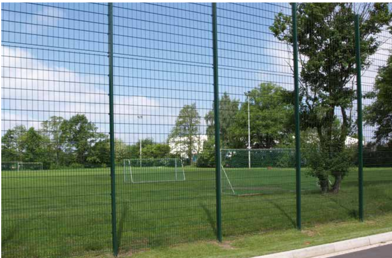
Ballfangzaun, 6 m hoch in grün pulverbeschichtet
