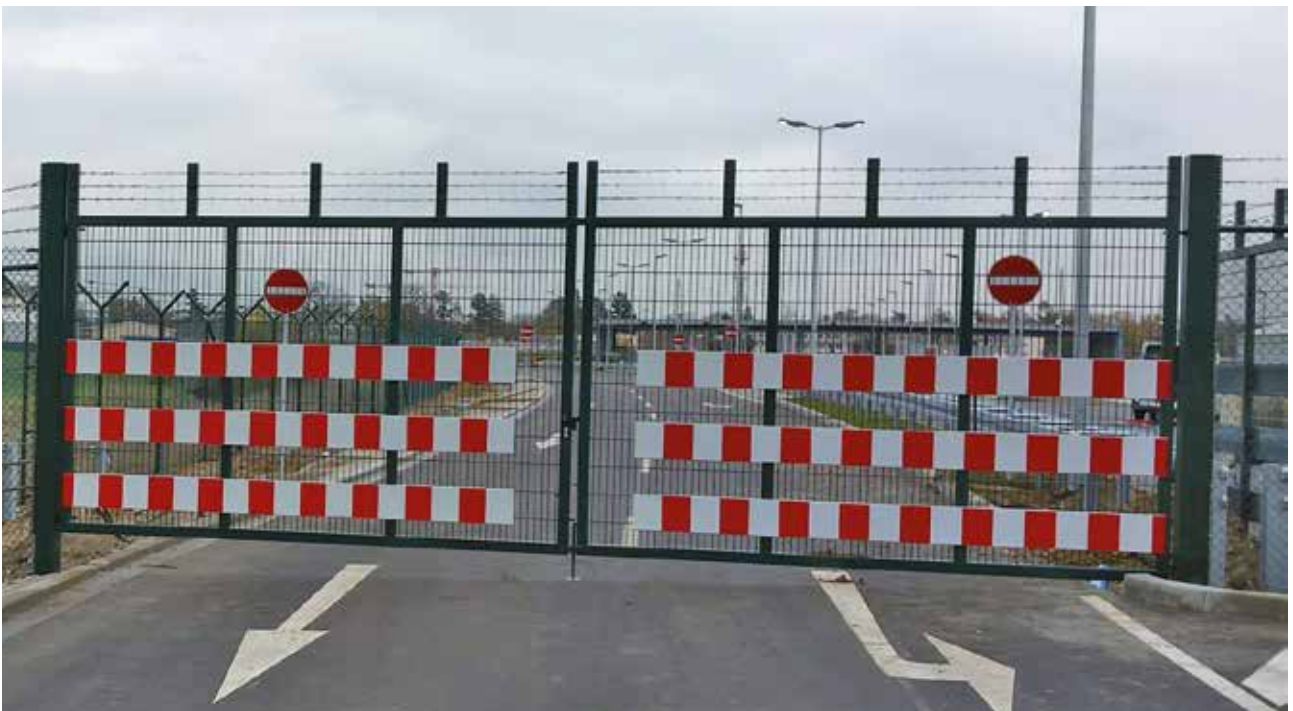
Drehflügel, 2-flügelig, mit Doppelstabfüllung, moosgrün pulverbeschichtet
