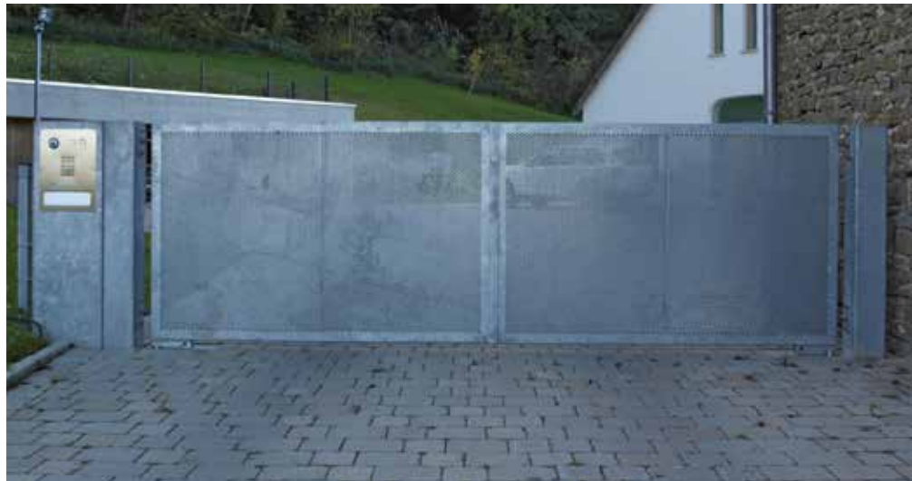
Tor mit verzinkter Lochblechfüllung
